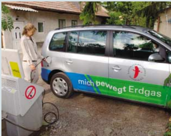
BETANKUNG MIT ERDGAS – Kompression auf 80 bar im Stahl-Drucktank des Touran. Die Haustankstelle ist bequem – doch das öffentliche Gas-Tanknetz wächst. Wer mit Methan fährt, ist nicht nur umweltfreundlicher unterwegs, er berappt auch weniger für den (landschaftszerstörenden) Straßenbau.
